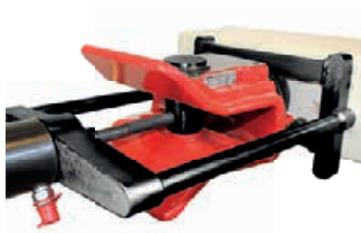
Mit dem Werkzeug wird die gesamte Zugvorrichtung aus ihrem Halter gezogen, wenn ein Austausch oder Service durchgeführt werden muss. Es ist ein sehr zeitsparendes Werkzeug, das den Ausbau erleichtert. Das Werkzeug wird zusammen mit einem der folgenden Zylinder angewandt: 1090-02 oder 01-00030.
