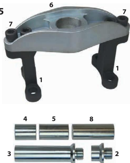
**03-00016-32T** Wird mit 32-Tonnen-Hydraulikzylinder 03-00028 angewendet. Die starke Konstruktion ermöglicht eine Belastung von 32 t und Hammerschläge in Druckrichtung (am Zylinder) beim Herauspressen. Dadurch können auch Naben mit Einheitslager an geraden Wellen gelöst werden.
