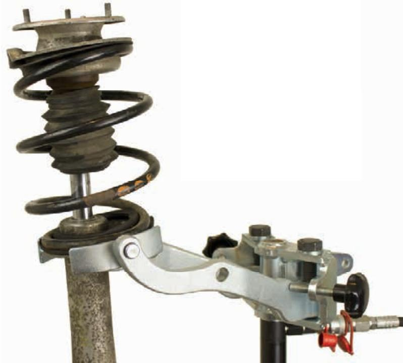
Das Federwerkzeug kann auch bei der Trennung von Achsschenkeln und Federbeinen zur Entlastung der Federbeine verwendet werden. Dies erfolgt direkt im Fahrzeug und reduziert die Arbeitszeit wesentlich.
