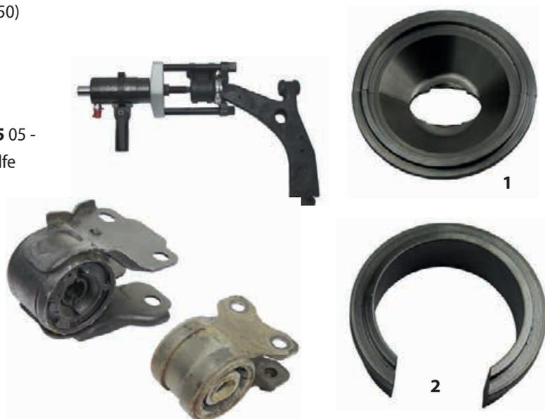
Wird zusammen mit Pressbügel 1090-55-B und Hydraulikzylinder 1090-03, 01-00030, 1090-02-WAL oder 03-00015 verwendet.
