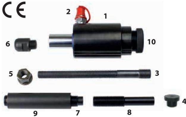
Bei Anwendung des Schlagkörpers 1086-6 kann der Druck des Hydraulikzylinders mit Schlagkraft kombiniert werden. Zum Beispiel beim Herauspressen von festgerosteten Antriebswellen. Gewicht: 2,8 kg. Hublänge: 50 mm.
